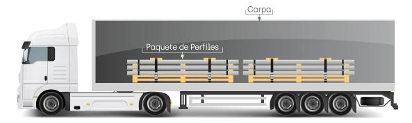
Para el transporte de perfiles se debe contar con estibas para soportar el material y se debe asegurar el mismo para impedir que se desplace durante el transporte, ya que esto genera rayado y maltrato.
